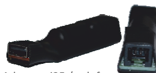
Adapter rj25 / usb for tilslutning i CG Link / DAT-Boks
